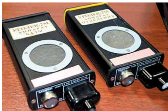
Под землей главное — связь. Ее обеспечивает «Уголек-2»
