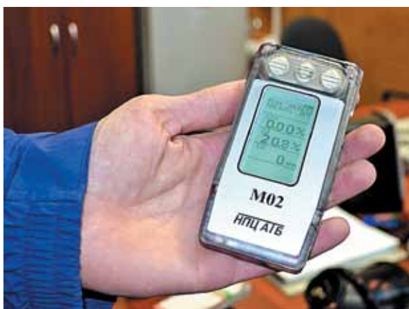
Все данные о концентрации метана — на экране газоанализатора серии М 02-01
